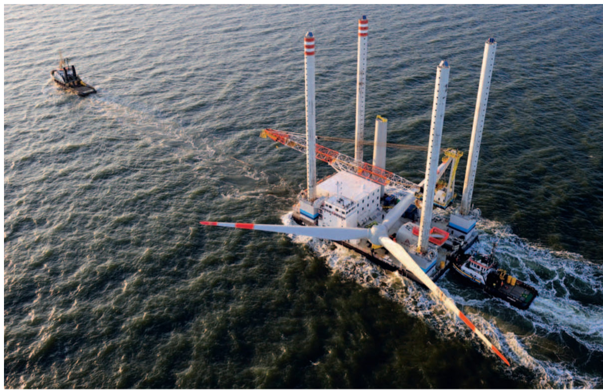
Transport eines Rotors in den Offshore-Windpark Alpha Ventus, 45 km nördlich der Insel Borkum.
